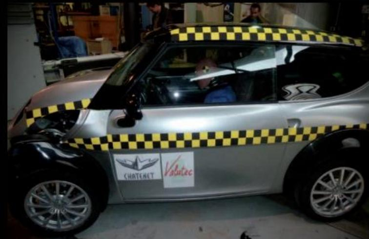
Essai de choc frontal véhicule sur barrière CEVE réalisé à une vitesse de 38,4 km/h.
